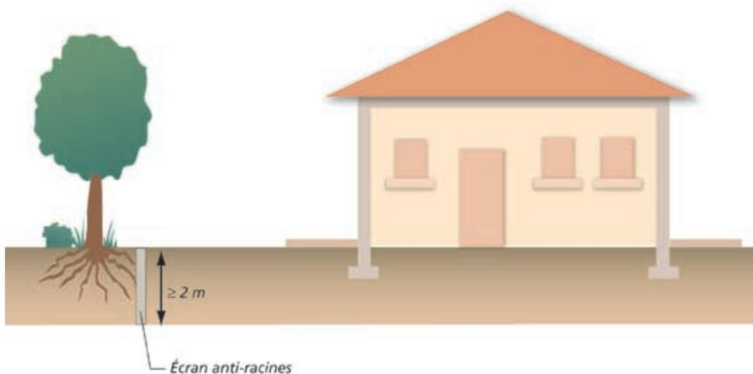
**Précautions de mise en œuvre :** L'écran anti-racines doit pouvoir présenter des garanties de pérennité suffisantes, notamment vis-à-vis de l'étanchéité et de la résistance. Un soin particulier doit être porté sur les matériaux utilisés (caractéristiques de la géomembrane, etc). L'appel à un professionnel peut s'avérer nécessaire pour ce point, voire également pour la réalisation du dispositif.
